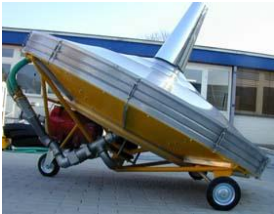
高温源が100~300℃で作動する低~中温型の太陽熱利用スターリングエンジン
