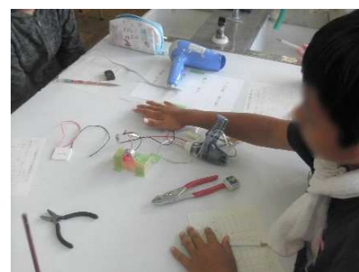
保冷剤と体温で発電し モーターを回す
