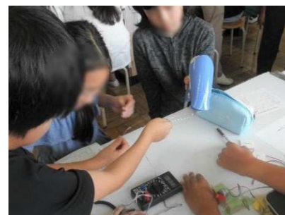
異種金属をねじり合わせ ドライヤーで温める
