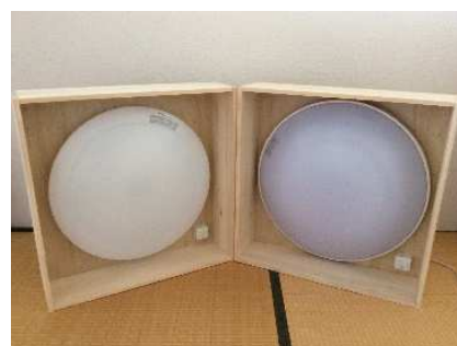
LED照明(左)と蛍光灯(右)の消費電力比較の実験装置
