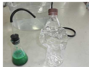
二酸化炭素を出す三角フラスコ(左)とつぶれたペットボトル
