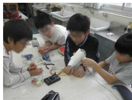
ペア線を熱して起電力を測定する
