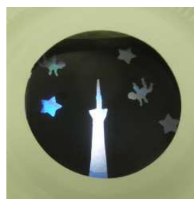
偏光フィルムを使った万華鏡 フィルムを回すと色が変わる
